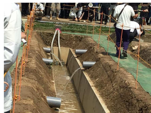
比較②：堰板・落水口の形状による効果の比較
