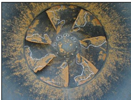
腐食した排水ポンプ場の羽根車
